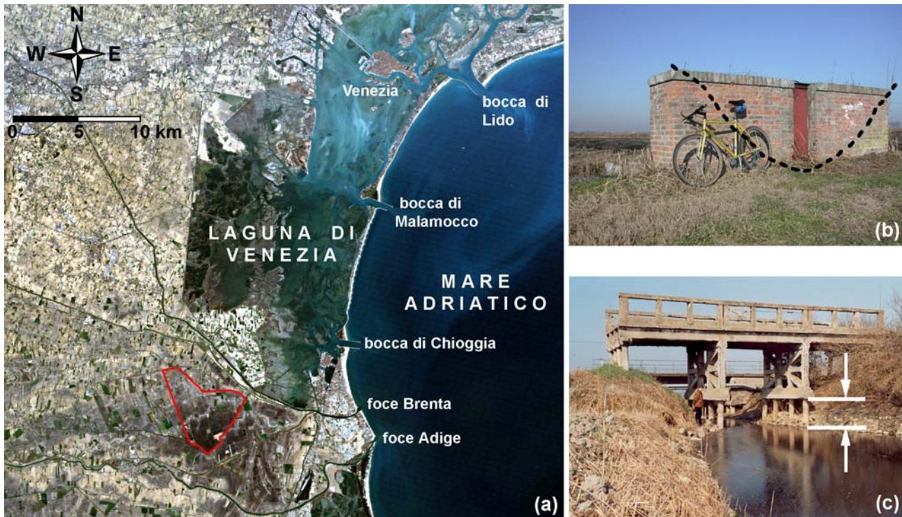
Figura1. (a) Vista dal satellite dell'area sud della Laguna di Venezia con l'ubicazione del Bacino Zennare oggetto di studio nel progetto VOSS. La colorazione più scura è indice di suoli ad alto contenuto organico. (b) e (c) Effetti della subsidenza causata dall'ossidazione delle torbe su alcuni manufatti idraulici della zona bonificata.
